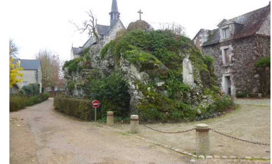
De nombreuses maisons présentent un rdc en moellons et des élévations en tuffeau (peu résistant à l'eau)
